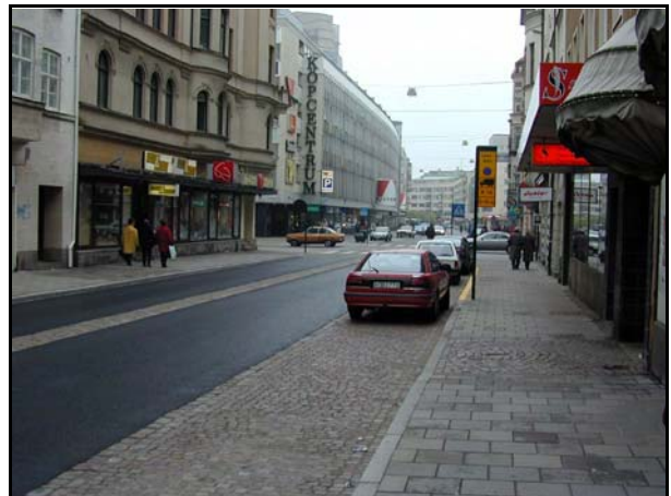
Såväl parkeringsytor som mitt linjen har markerats med avvikande beläggning (smågatsten). Södra Förstadsgatan, Malmö.
