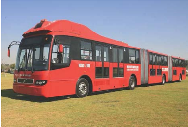
Figur 3.29 Dubbelt ledad BRT buss (Volvo) med hög-entré
