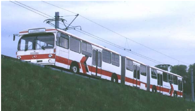
Figur 2.1 O-Bahn fordon på bana och med strömvtagare. Fordonet kan köra (automatiskt) i två riktningar.
