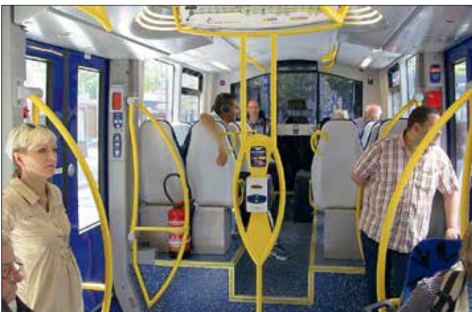
Interiör från en av duospårvagnarna i Mulhouse. Man noterar högt steg upp till golvet över ändboggierna.
