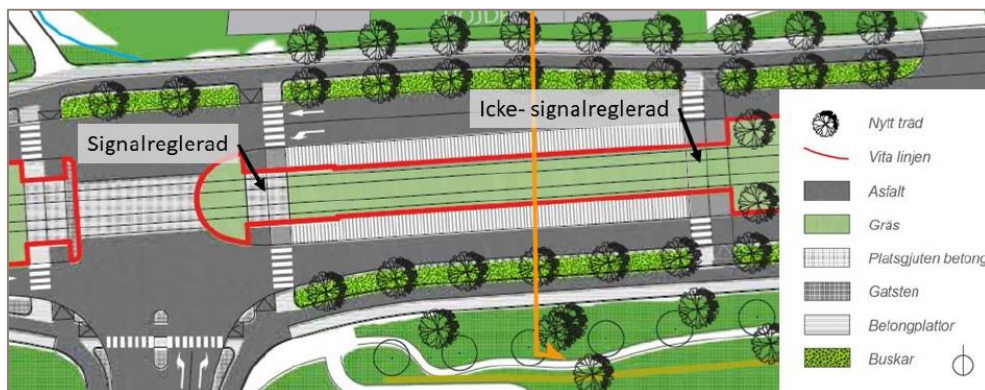
Figur 14. Hållplats Telefonplan med två spårövergångar markerade. Markbeläggningen mellan plattformarna inte är gräs som illustrationen visar utan gatsten. Källa: Bengtsson & Gertson (2021).
