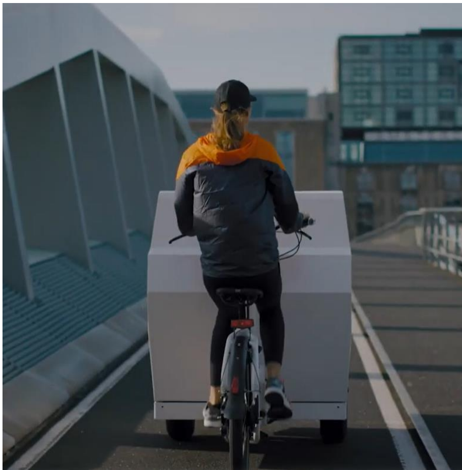
Figur 4 Cykelmodellen Tender från cykeltillverkaren Urban Arrow som med sin bredd på 114 cm tillhör bland de bredaste godscykelmodellen. Bildkälla: BultenBike
