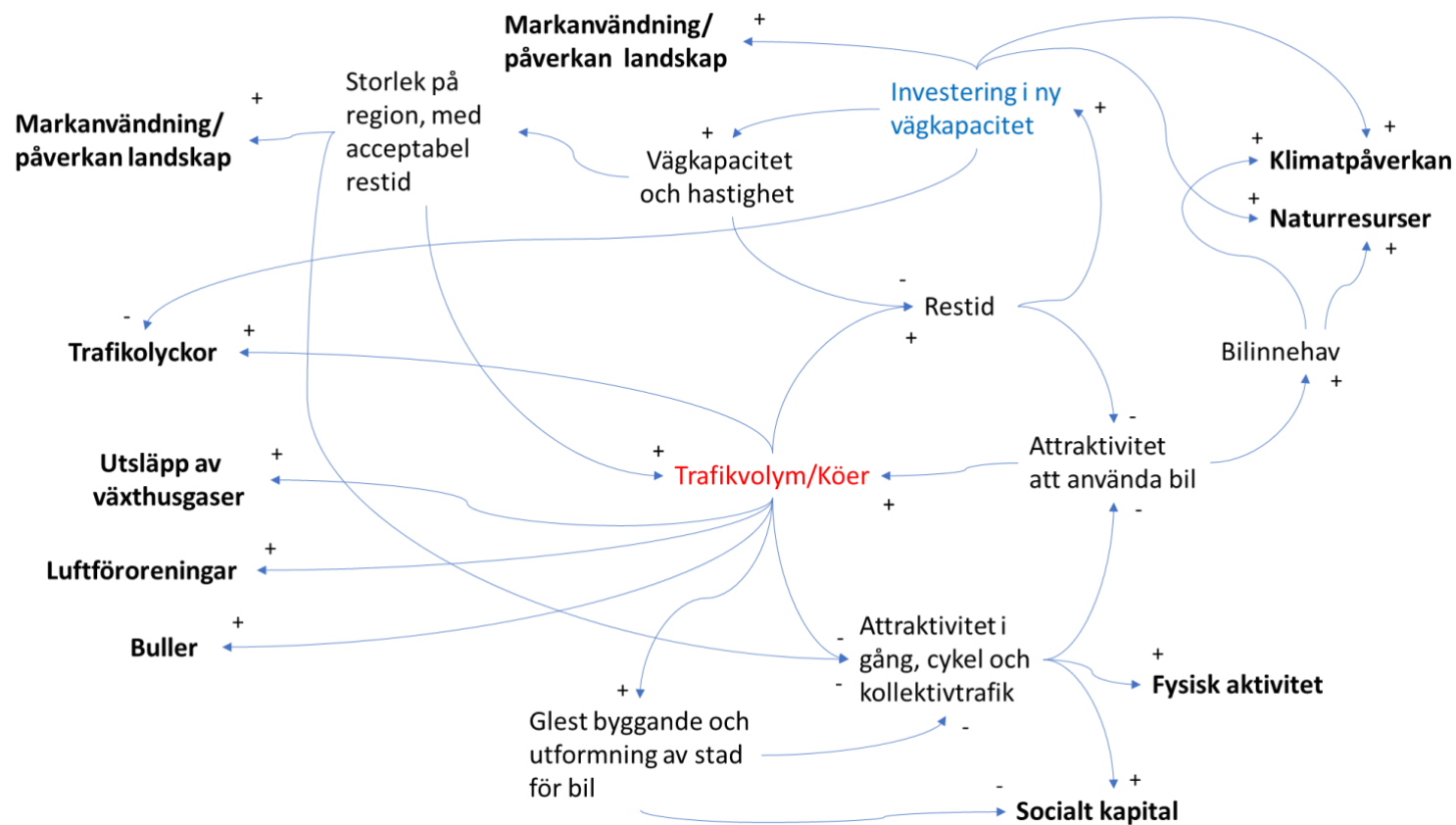
Figur 6-1 Systemkarta – CLD diagram för inverkan av investering i ny vägkapacitet på trafik, transporter, miljö och samhälle. Systemkartan visar hur investering i ny vägkapacitet leder till direkta effekter på markanvändning påverkan på landskap, klimat och användning av naturresurser samtidigt som det indirekt leder till regionförstoring, mer trafik och effekter på trafikolyckor, utsläpp av växthusgaser, luftföroreningar, buller, glest byggande, negativ påverkan på det sociala kapitalet och försämrad fysisk aktivitet.
